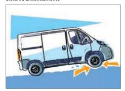
Il sistema contrasta gli effetti sittamento di una o di entrambe le ruote motrici in condizioni di scarsa aderenza, intervendo sui freni o riducendo temporaneamente la potenza enogata dal motore.
