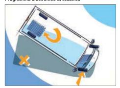
Il sistema interviene in situazioni di emergenza, come ad esempio manovre di scarto improvvise per evitare un ostacolo. Effettua il monitoraggio di parametri quali l'accelerazione laterale, la velocità, l'aderenza a terra l'angolo del volante. Elabora i dati e, se necessario, interviene sulla coppia motrice e sull'impianto frenante per riportare il veicolo in condizioni di perfetta stabilità.
