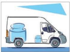
Mantengono il veicolo in assetto costante, indipendentemente dall'entità e dalla disposizione del carico, aumentando la sicurezza e il comfort di marcia. Le sospensioni sono controllate da una centralina che agisce su un sistema di sospensioni pneumatiche. Lo stesso sistema consente, a veicolo fermo, di alzare o abbassare il piano di carico di 70 mm.
