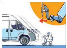
Incrementa automaticamente la pressione del circuito frenante durante una frenata d'emergenza, consentendo la riduzione degli spazi d'arresto, agendo direttamente sul servofreno. Se il veicolo è dotato di ESP, analoga funzione è svolta dall'HBA (Hydraulic Brake Assistance).
