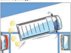
Forniscono a chi guida un'informazione sulla distanza tra il veicolo e gli ostacoli retrostanti. Il sistema si attiva con la retromarcia inserita e funziona tramite 4 sensori ad ultrasuoni. L'avvicinamento ad un ostacolo è segnalato da un segnale acustico intermittente. Un segnale acustico continuo indica il limite massimo di avvicinamento.
