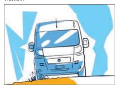
L'innovativo sistema di controllo Traction+ incrementa la motricità del veicolo su terreni difficili ed a scarsa aderenza. In condizioni di bassa o nulla aderenza su una ruota motrice, la centralina del sistema rileva lo slittamento e la frena, trasferendo la coppia motrice sulla ruota con maggiore presa sul terreno. In questo modo il disimpegno del veicolo diventa più agevole assicurando la migliore guidabilità e stabilità direzionale possibile.
